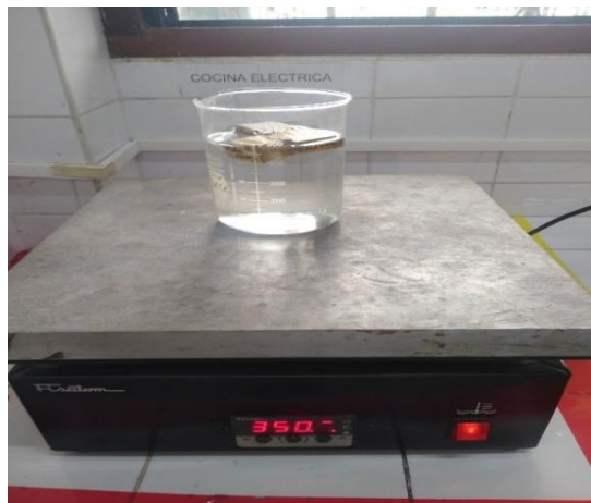
Figura 10. Cocina eléctrica a 350 ° para el ablandamiento de las muestras.
