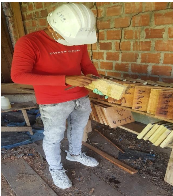
Figura 10. Medición de la penetración
