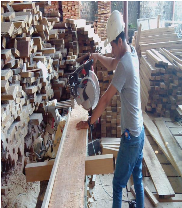
Figura 04. Obtención de las muestras de madera para los ensayos de preservación
