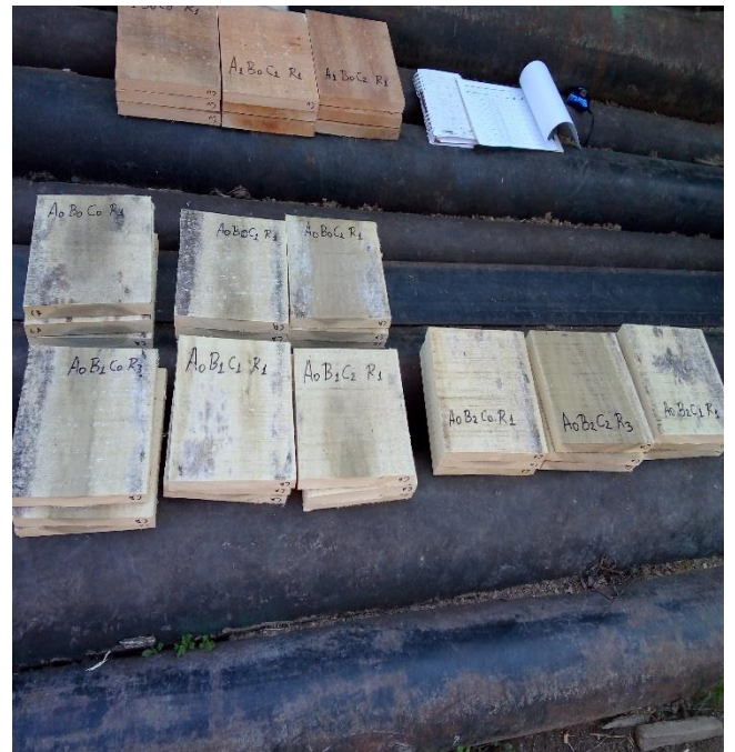
Figura 05. Codificación de las muestras de madera para los ensayos de preservación
