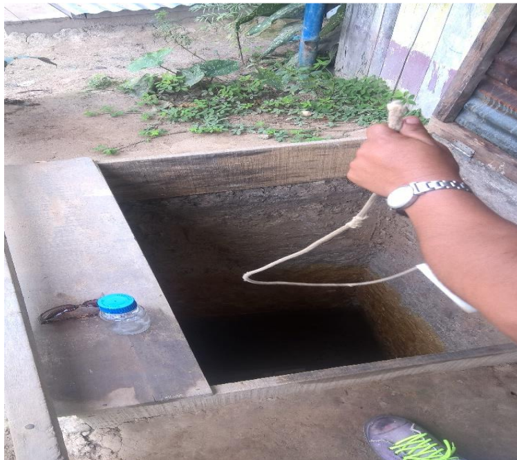
Foto N° 5. Toma de muestra de agua de pozo rústico
