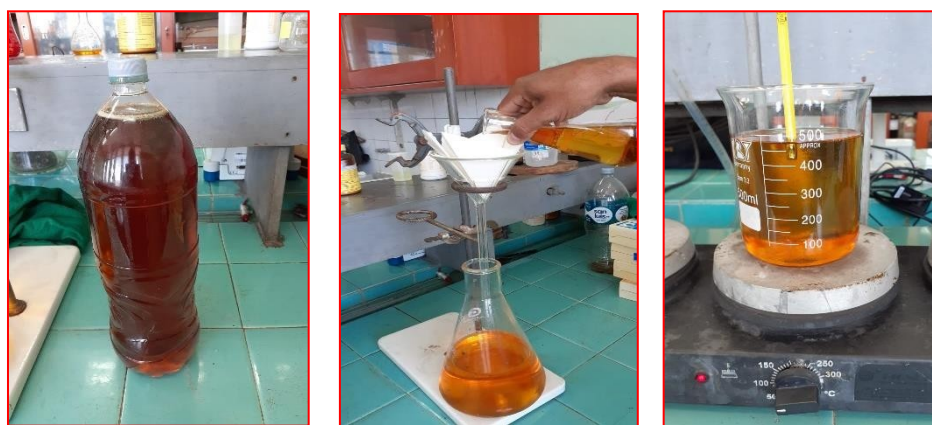
Figura 2: Decantación, filtración y secado del aceite de fritura usado.
