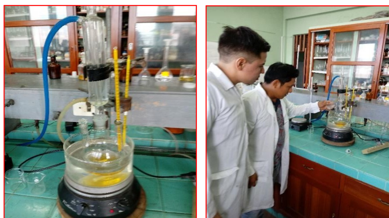
Figura 3: Reactor Batch usado en la reacción de transesterificación
