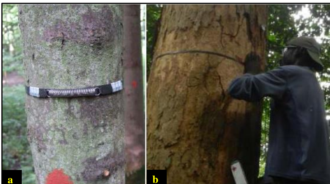
Figura 11. Dendrómetros a) Dendrómetro instalado en una especie forestal; b). Ejemplo de medición de los dendrómetros.
