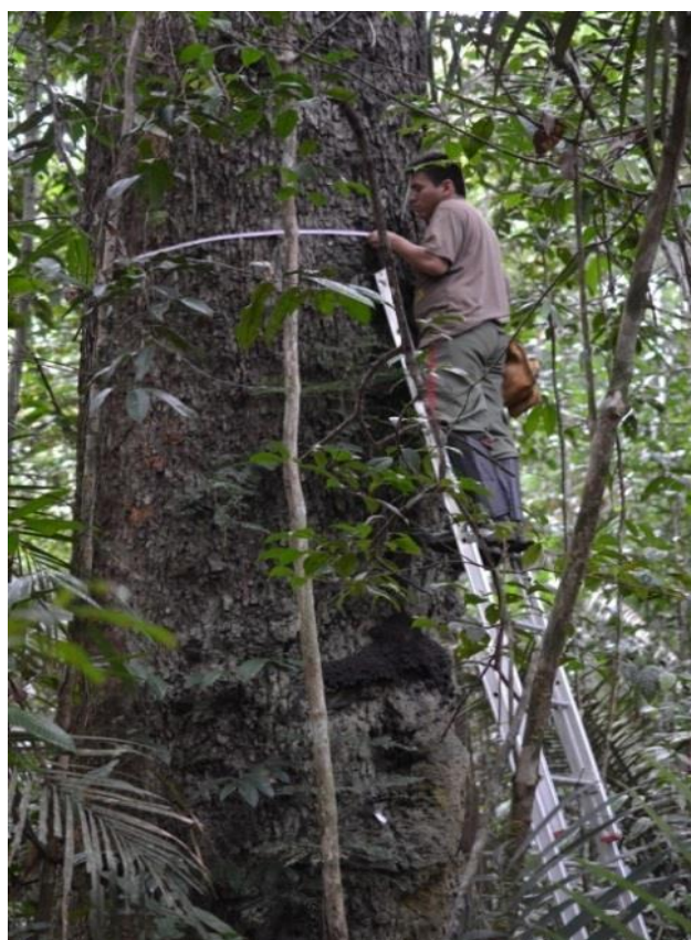
Figura 12. Forma de la medición de dendrómetros para aquellos árboles que fueron instalados por encima de los 2 metros de altura.
