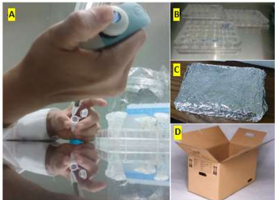
Figura 15. Ensayos de inhibición de crecimiento de hipocótilo. A) Colocación en placas de 24 pocillos las semillas de Arabidopsis . B) Aplicación de los péptidos. C) Envoltura de la placa con papel aluminio. D) Se guardaron los tratamientos en una caja de cartón.
