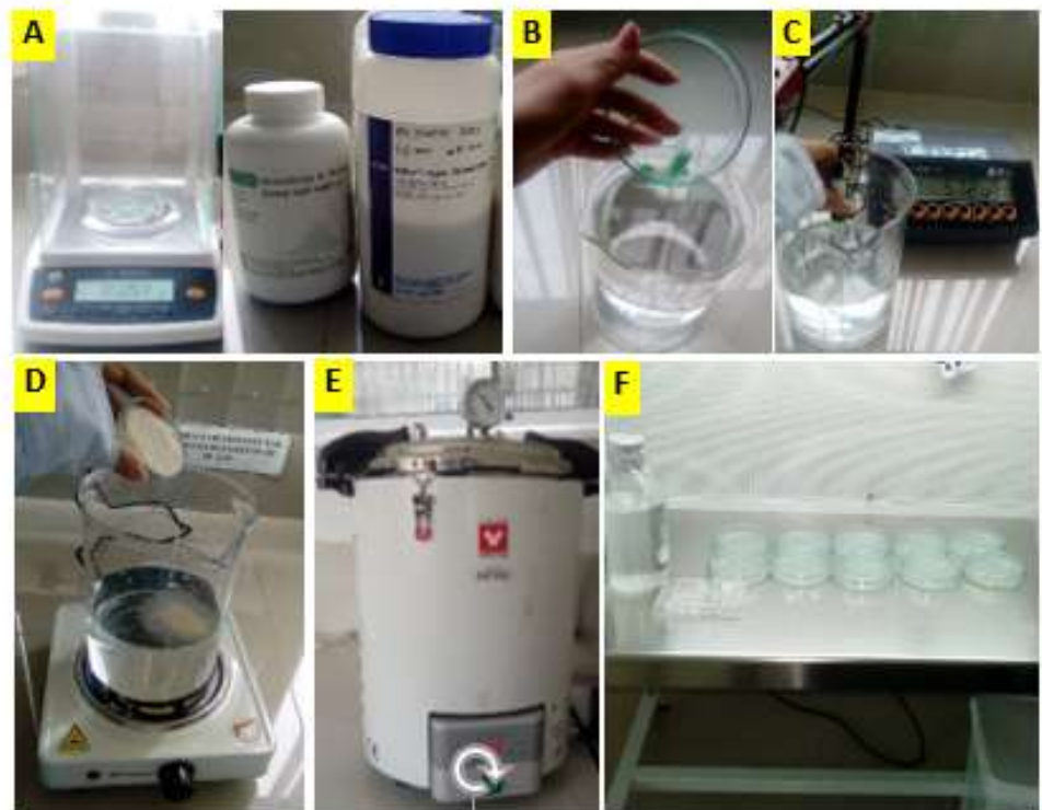
Figura 10. Preparación medio de cultivo para siembra de semillas de A. thaliana . A) Pesado de Medio, B) Homogenización de los medios. C) Medición del pH. D) Dilución del agar. E) Autoclavar los medios de cultivo F) Plaqueo del medio de cultivo.
