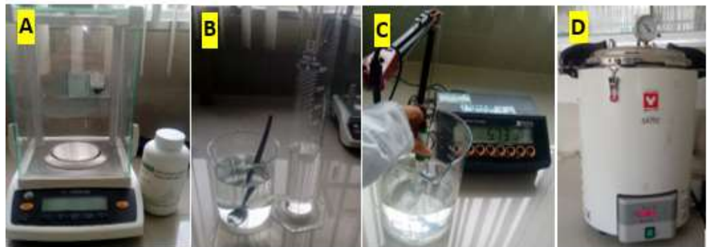
Figura 11. Preparación de medio de cultivo líquido. A) Pesar Medio Murashigue & Skoog. B) Homognizar agua destilada y Murashigue & Skoog. C) Medición del pH. D) Autoclavar.
