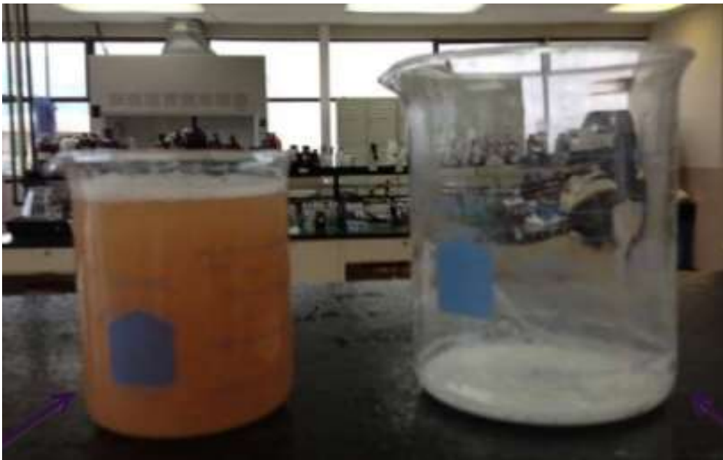
Foto 10: Ensayo de la prueba de Jarras
