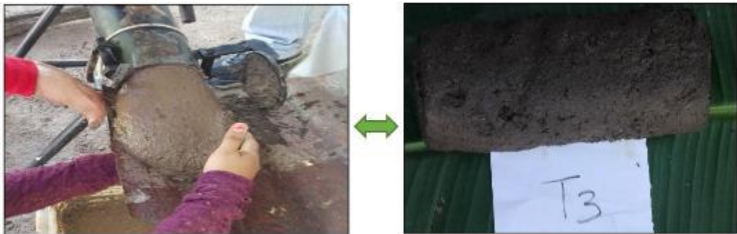
Foto 9. En las siguientes pruebas se puede observar que se obtuvieron resultados erróneos debido al exceso de aglutinante. Por ese defecto el equipo no consigue prensar en su totalidad el material por ser muy manejable y flácido.
