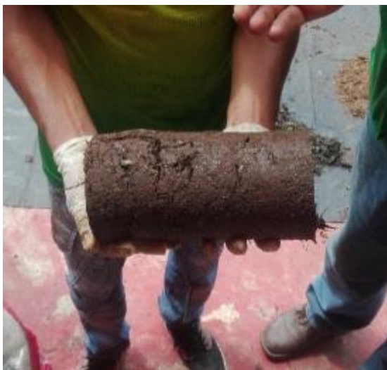
Foto 5. Briqueabono obtenido en la primera prueba, tuvo una buena calidad y consistencia.
