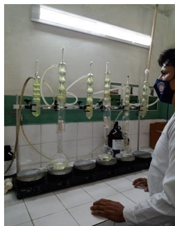
Destilación de hojas para la obtención del aceite
