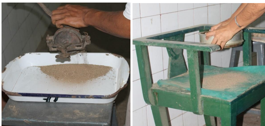
Foto 02 y 03: Tamizado de las muestras de suelo
