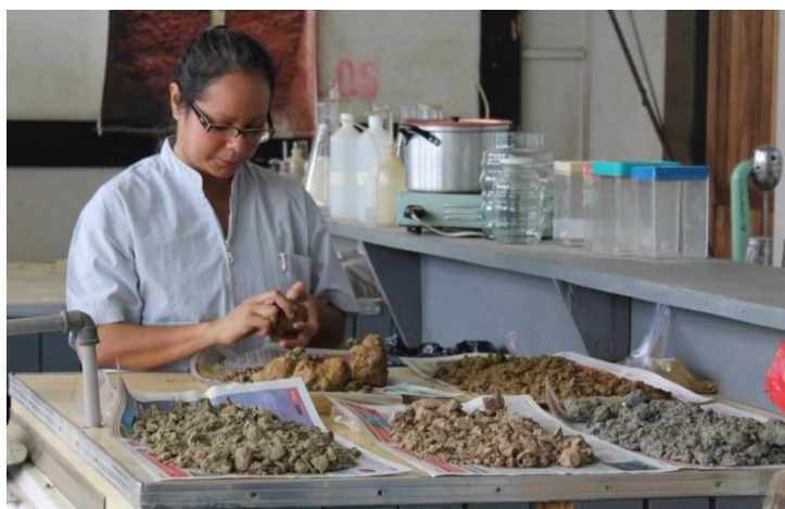
Foto 01: Secado de las muestras de suelo
