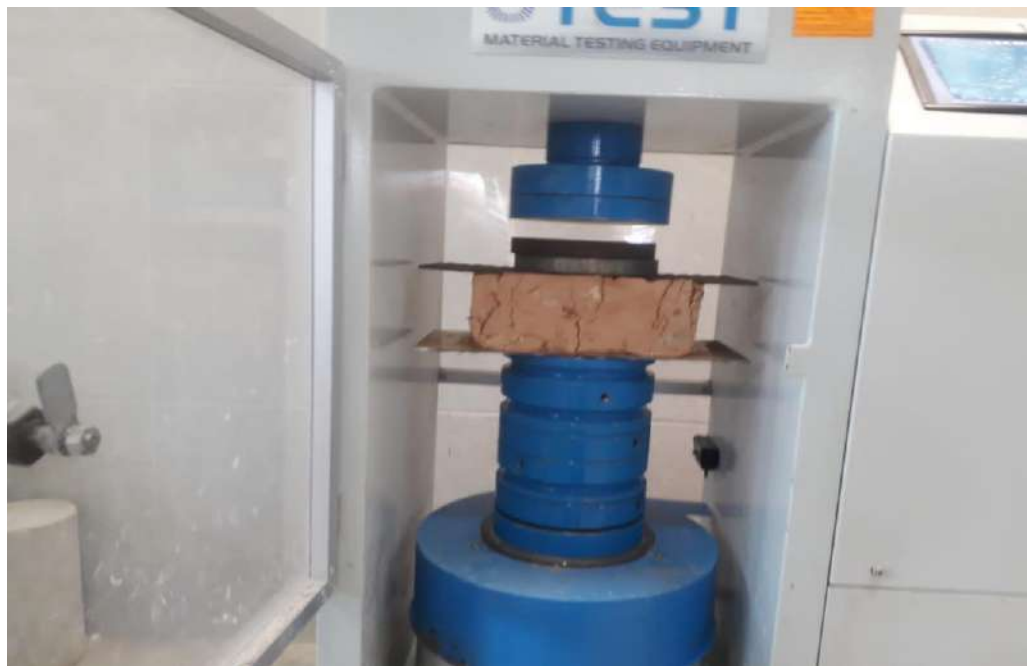
Foto 8. Prueba de compresión con la prensa hidráulica
