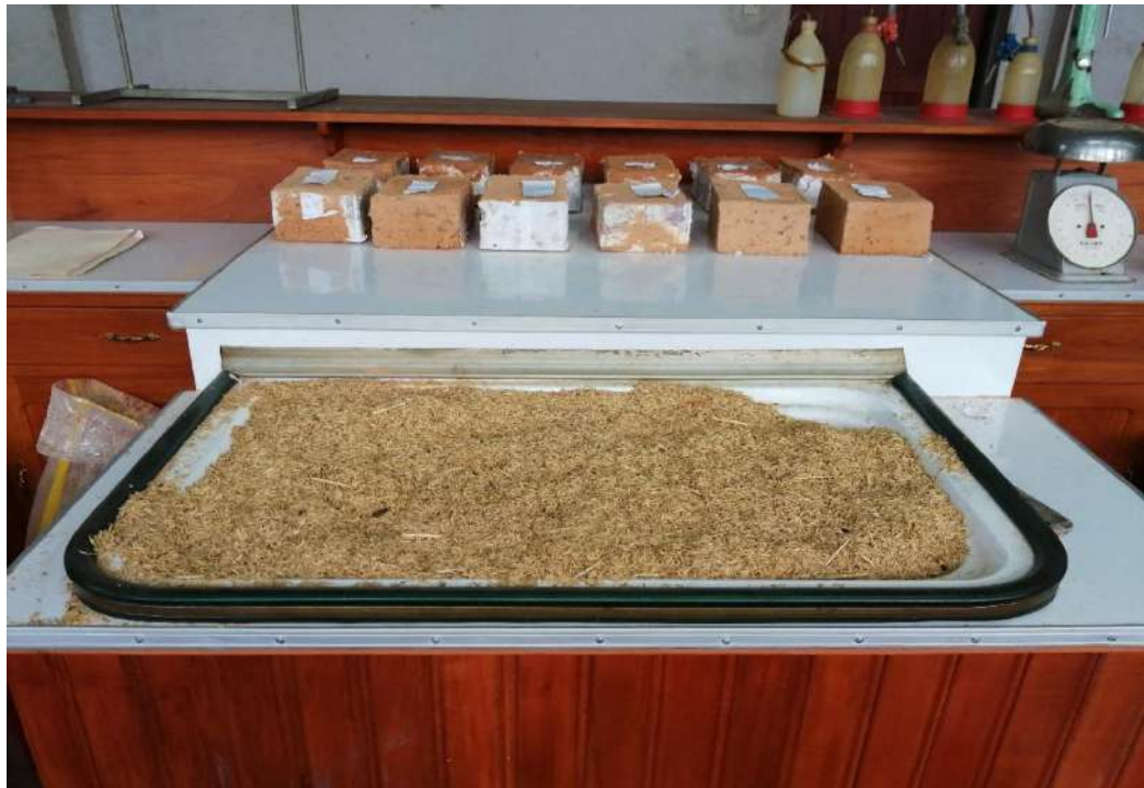
Foto 6. Cascara de arroz utilizado en la elaboración del adobe
