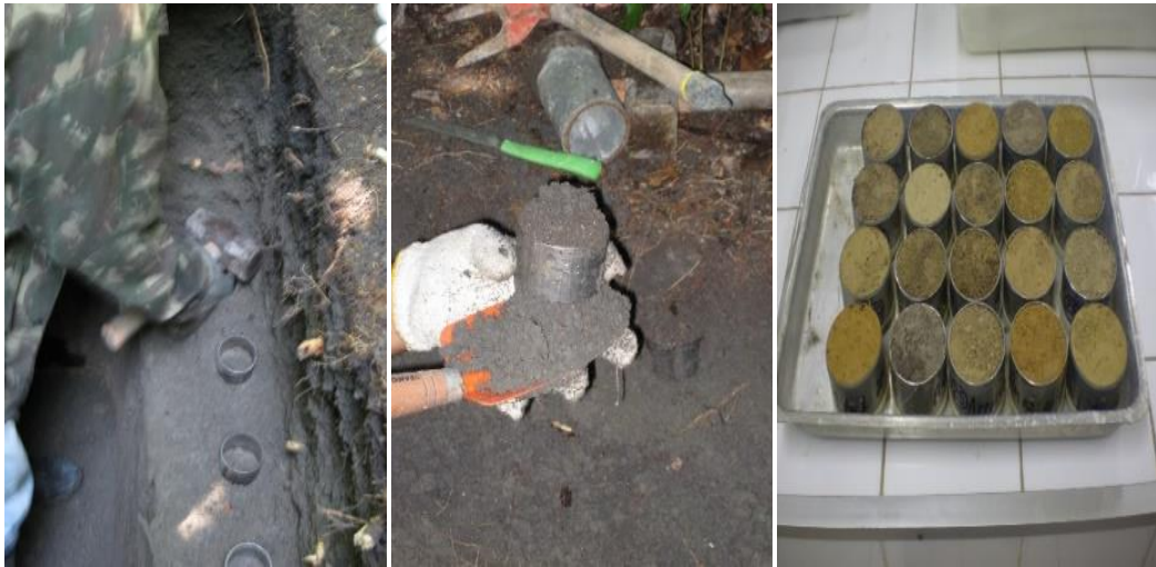
Figura 3. Colecta de muestras indeformada para cálculos de densidad aparente (DA), con ayuda del anillo volumétrico en las tres áreas de estudio.
