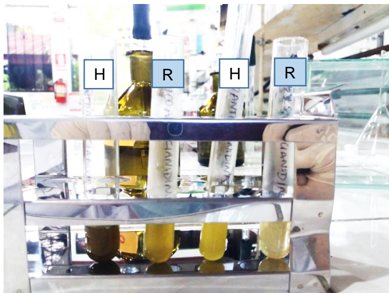
Figura 54. Identificación de leucoantocianidina en los extractos etanólicos y triclorometánicos de hojas y raíz de P. obtusifolium C.DC.
