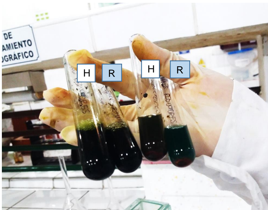
Figura 59. Identificación de azúcares reductores en los extractos etanólicos y triclorometánicos de hojas y raíz de P. obtusifolium C.DC.
