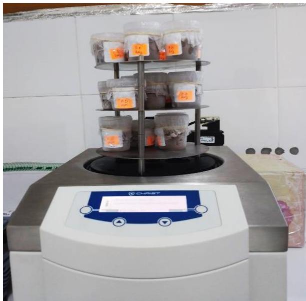
Figura 13. Extractos acuosos de hojas y raíz de P. obtusilimum C.DC. y P. divaricatum G. Mey. en el liofilizador
