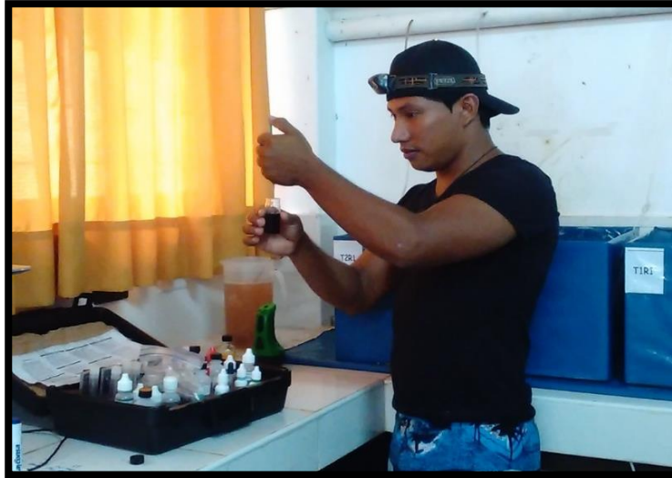
Foto 7.Utilización de Kit AQ-2 de LaMotte para el monitoreo de la calidad de agua.
