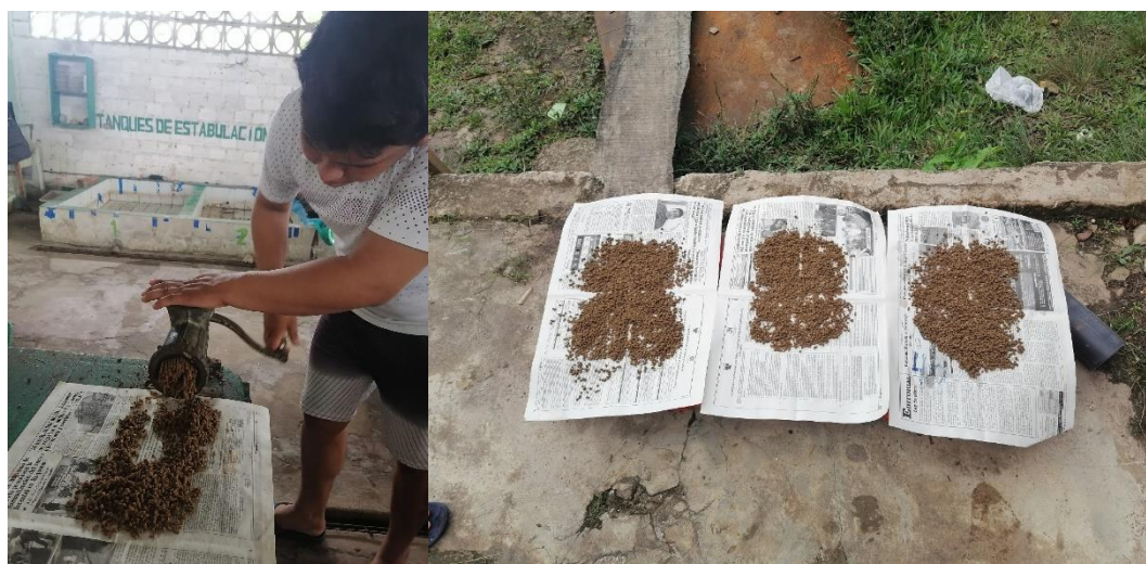
Figura 6. Peletización de los insumos y secado del alimento a temperatura ambiente
