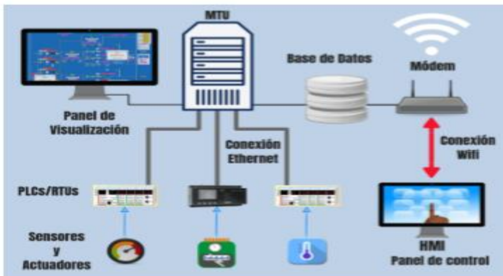
FIGURA 17: COMPONENTES DEL SISTEMA SCADA
