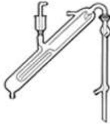
**Figura N° 4. Equipo Semi- Micro Kjeldhal**
