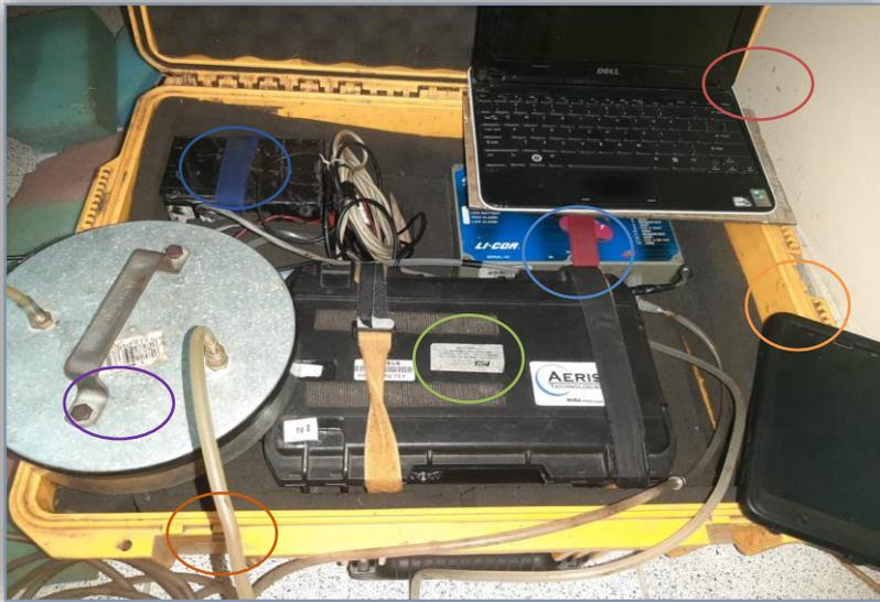
Instrumentos para medir la concentración de gases:
