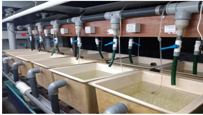
Figura 05. Ubicación de los tanques en el sistema de recirculación de agua
