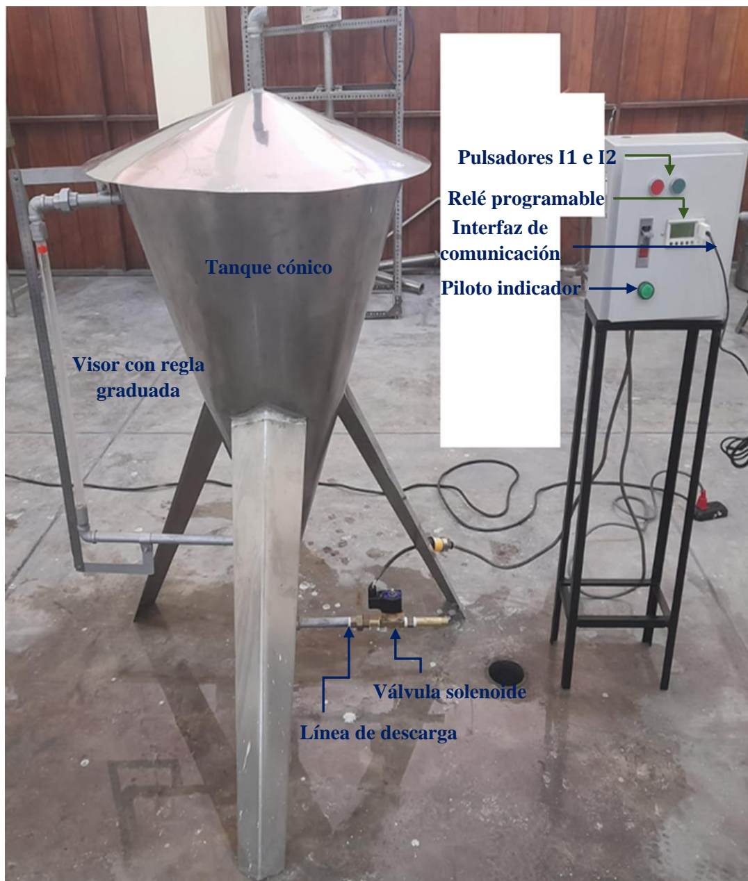
Figura 22. Vista real del equipo para el drenaje de líquidos en tanques cónicos, después de ser implementado mediante el sistema automatizado.
