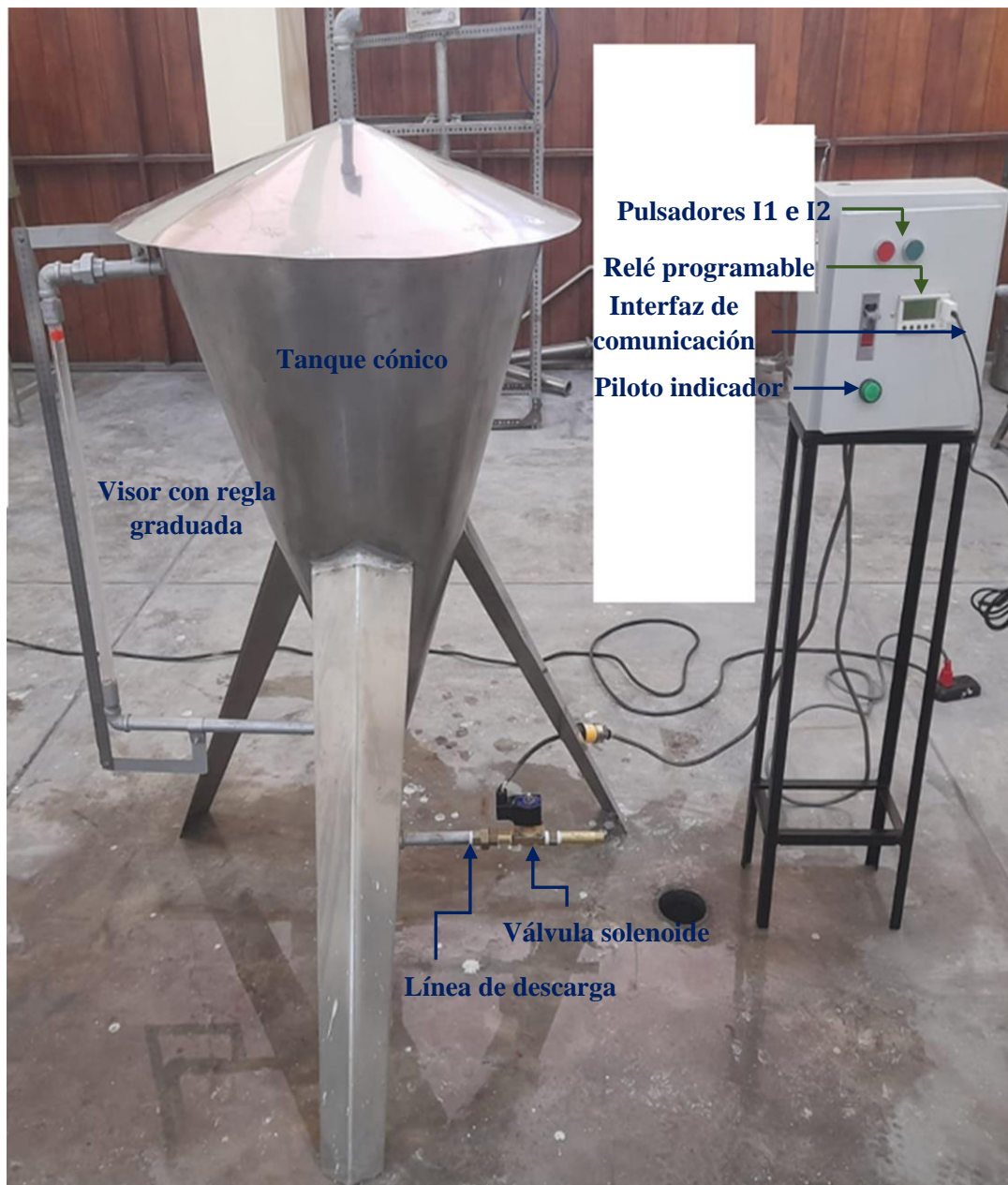
Figura A1. Vista real del equipo para el drenaje de líquidos en tanques cónicos, después de ser implementado mediante el sistema automatizado.
