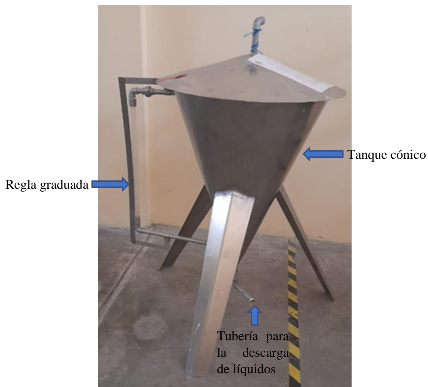
Figura 14. Equipo para el control automático del drenaje de líquidos en tanques cónicos, antes de ser implementado con el sistema automatizado.
