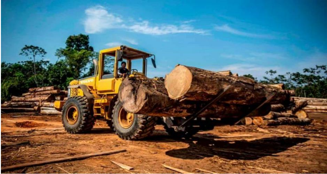
Figura 04: Cargador frontal transportando madera en trozas para su almacenamiento
