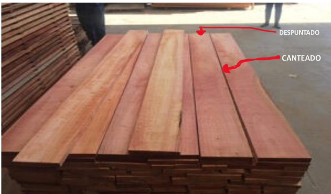
Figura 07: Piezas o tablas a granel después del proceso de aserrío (canteadas y despuntadas)
