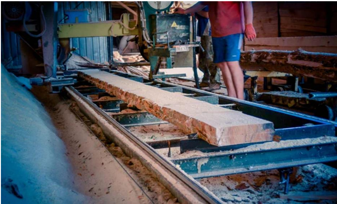
Figura 06: Sierra principal y produciendo tablones de madera
