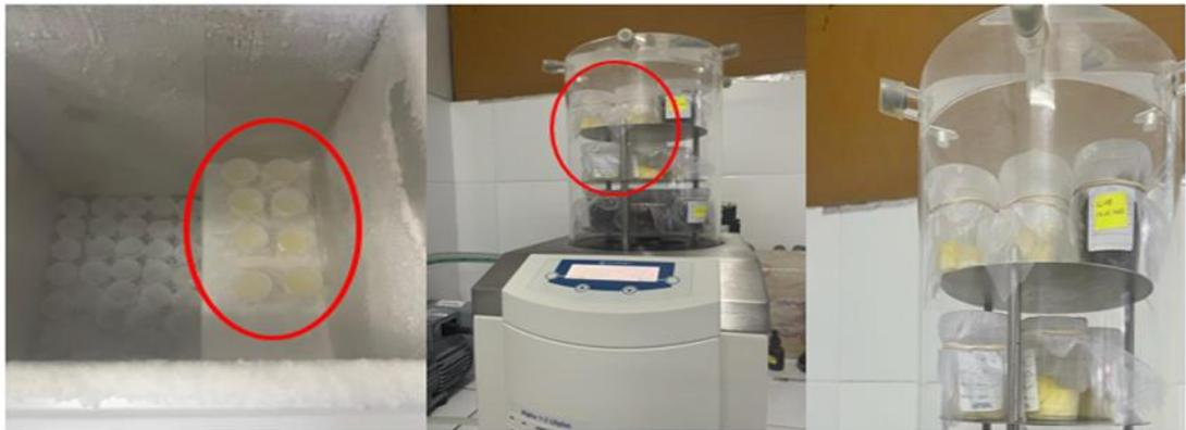
La solución obtenida se congeló a temperaturas de  $-56\text{ }^{\circ}\text{C}$  (24 horas), los recipientes fueron llevados a la maquina liofilizadora, por de 72 horas a presión de 0.030 mbar (milibar) con temperatura a  $-50\text{ }^{\circ}\text{C}$ .
